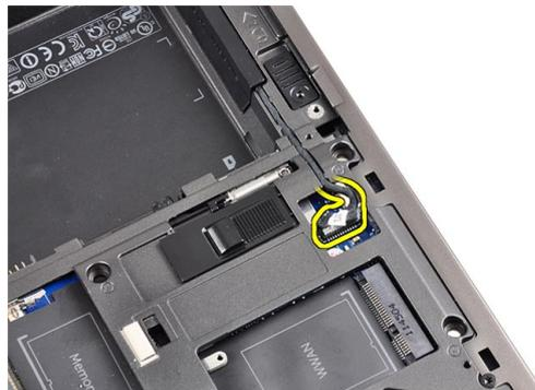
5. Desconecte o cabo do conector USH.
