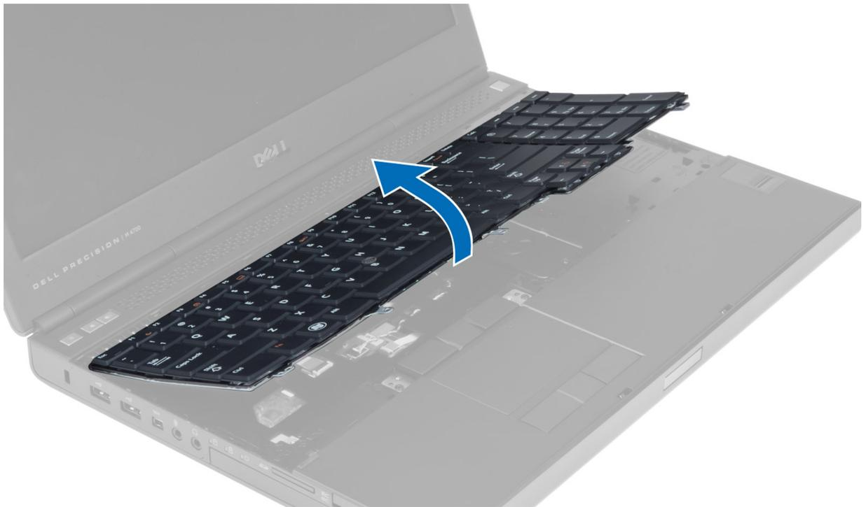
5. Desconecte o cabo de dados do teclado da placa do sistema e remova o teclado.
