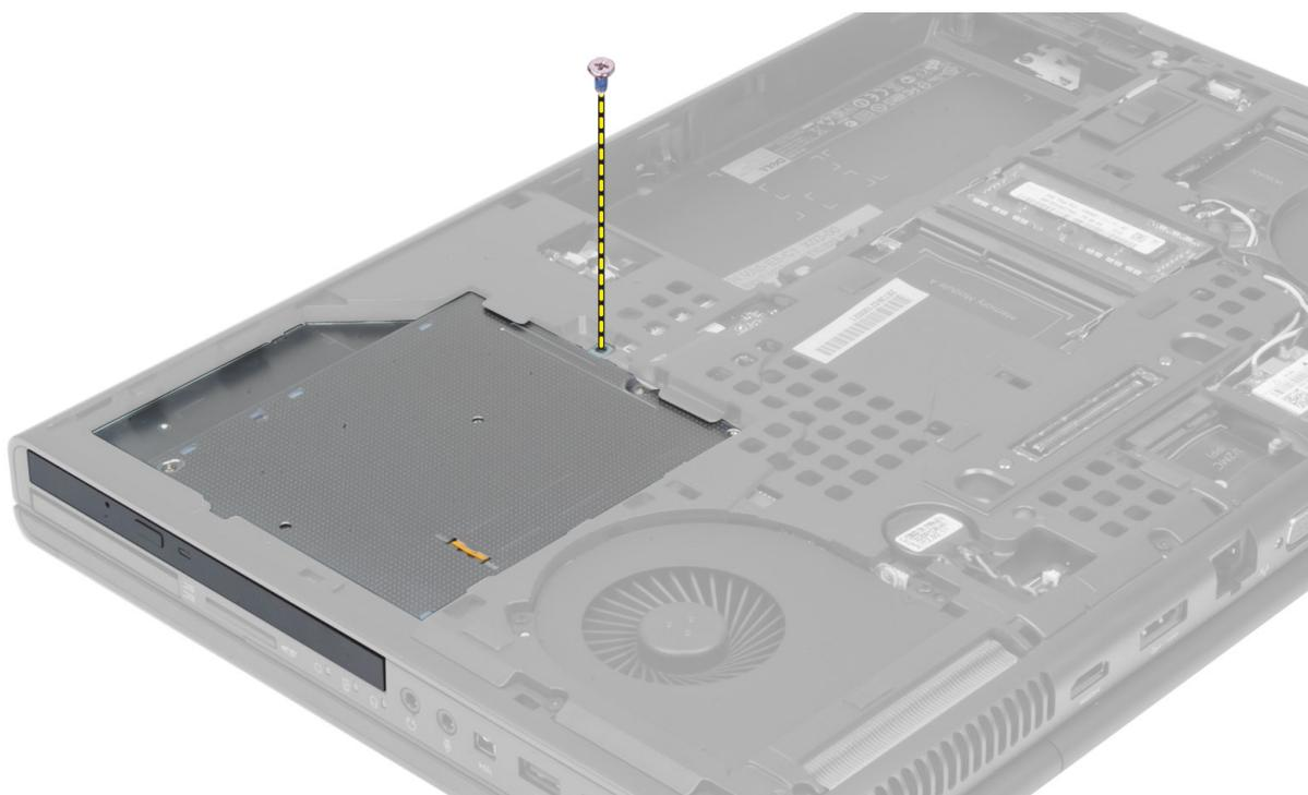
4. Levante e deslize a unidade óptica para fora para removê-la do computador.
