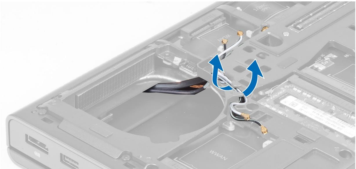
4. Remova os cabos da antena dos canais de roteamento.
